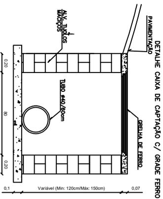
DETALHE CAIXA DE CAPTAÇÃO C/ GRADE FERRO
