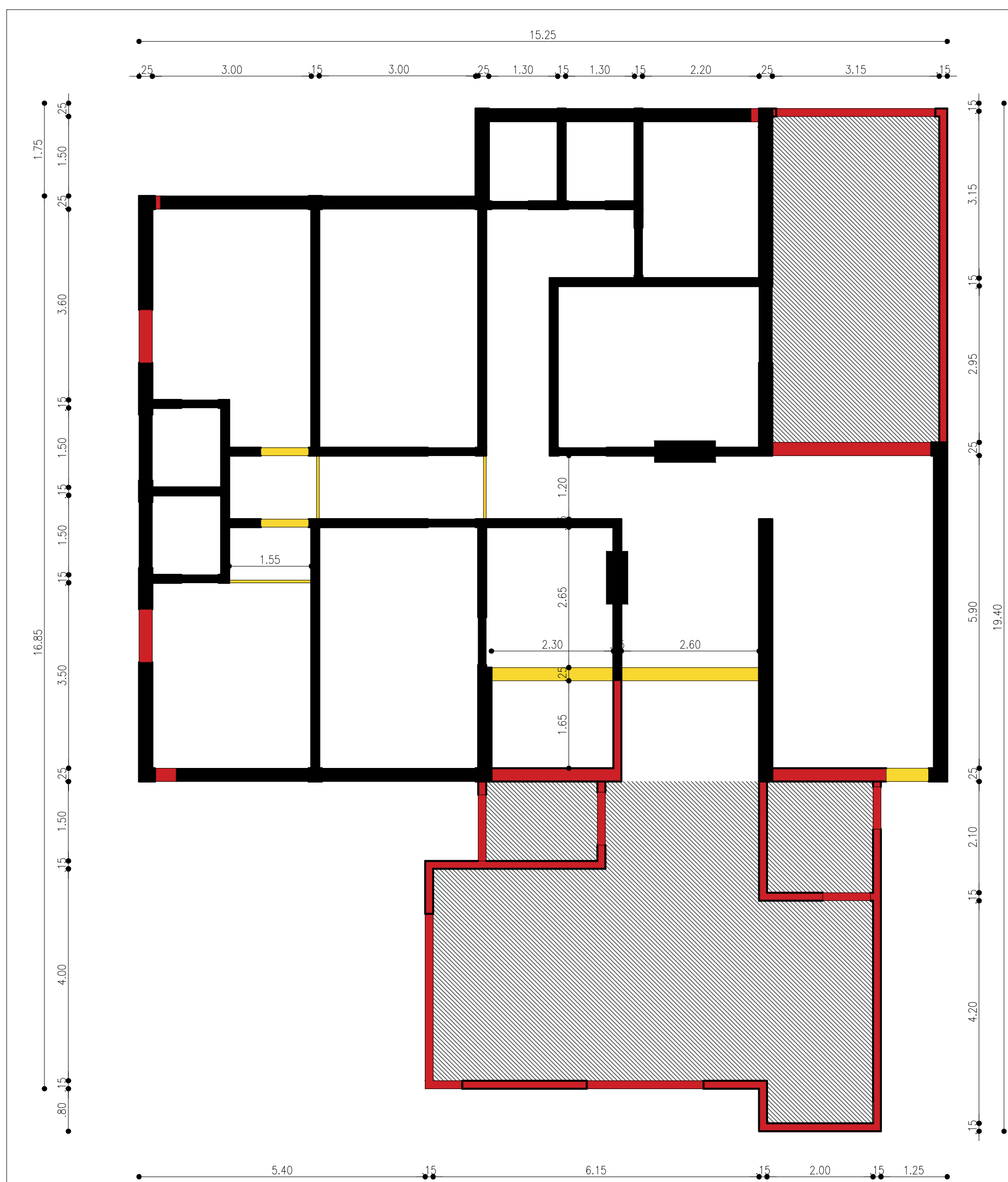
01 PLANTA BAIXA TÉRREO DEMOLIR/CONSTRUIR
